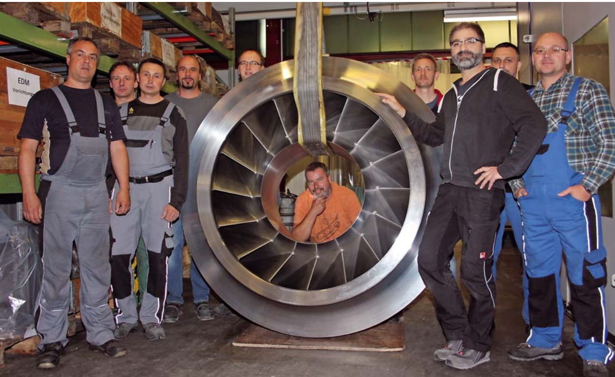
Beispiel für Präwests außergewöhnliche Fertigungskompetenz: Shrouded Impeller mit Außendurchmesser von 1780 mm. Bild: Präwest
