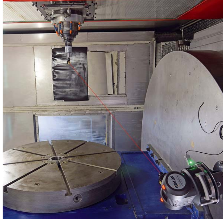
ISO-Verifizierung mit dem Laser-Tracer-NG: Bei der Platzierung des Messsystems ist keine Feinausrichtung notwendig. Bild: Präwest
