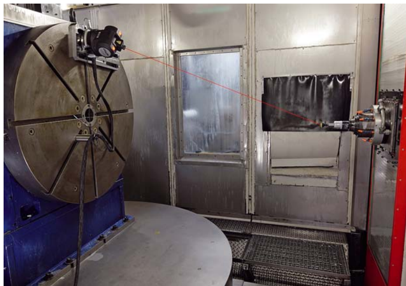
ISO-Verifizierung mit dem Laser-Tracer-NG: Bei der Platzierung des Messsystems ist keine Feinausrichtung notwendig. Bild: Präwest
